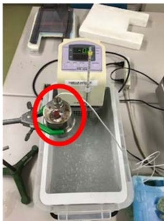
図 2 キャリブレーションの様子(図中赤丸が放射温度計)
