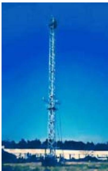
鉄塔の3高度(1.6, 12.3, 29.5m)に、気温計・露点温度計が、2高度(1.6, 29.5m)に超音波風速温度計が取り付けられています。
