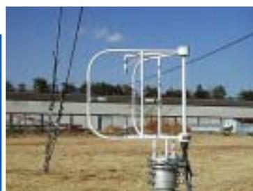
超音波を利用して三次元的な空気の動きと温度を捉えることができ、運動量と顕熱フラックスも観測しています。
