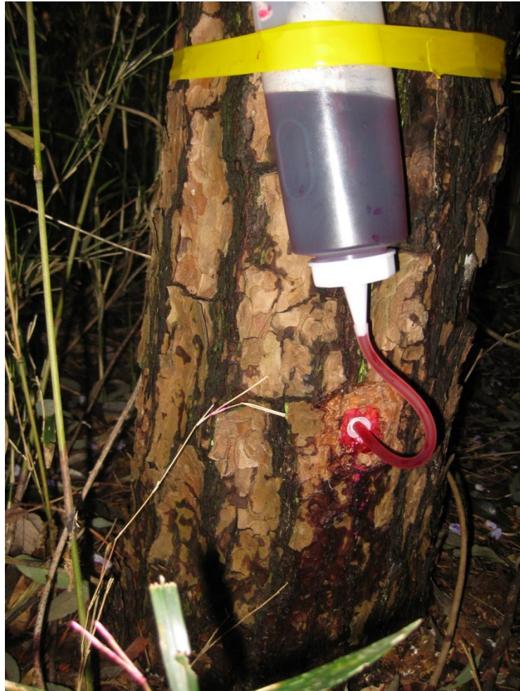
写真 8 染色液注入器（筑波大学陸域環境センター内 アカマツ林での予備実験にて撮影. 現地でも全く同様の 器具で実験を行った.）
