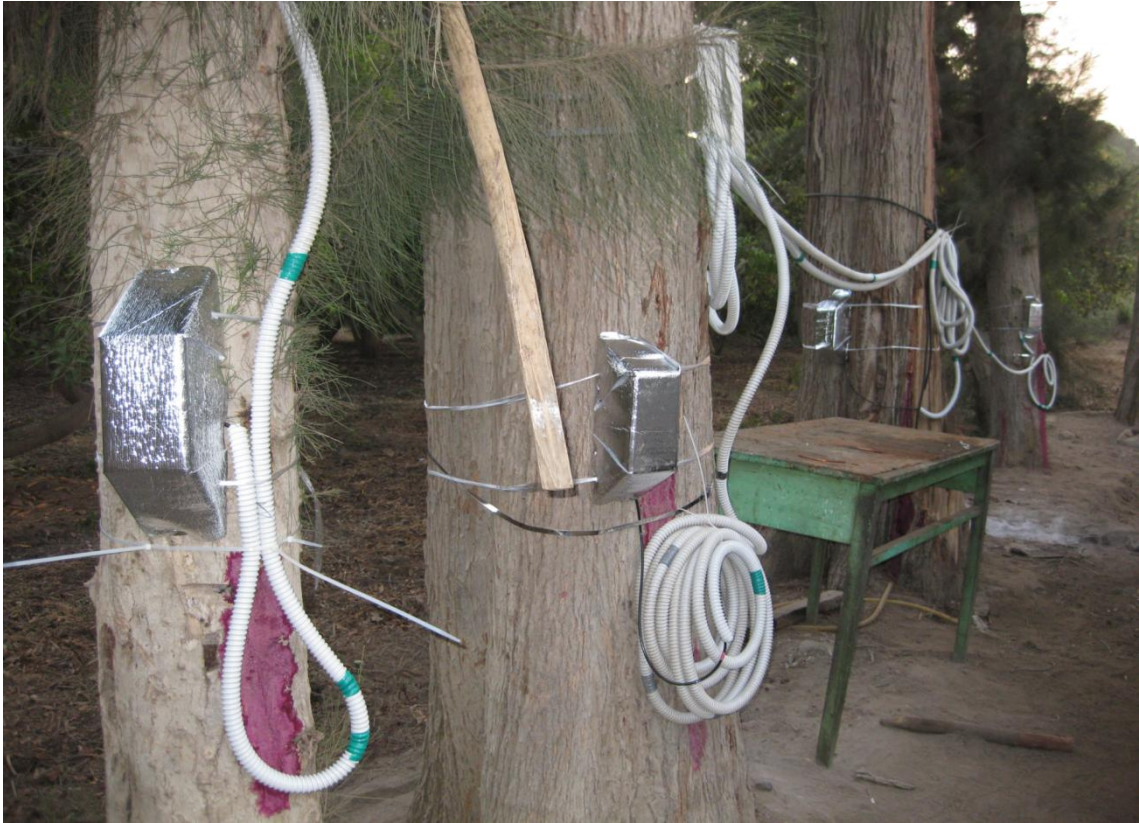
写真 2 サンプル 6~3 番に設置した sapflow sensor
