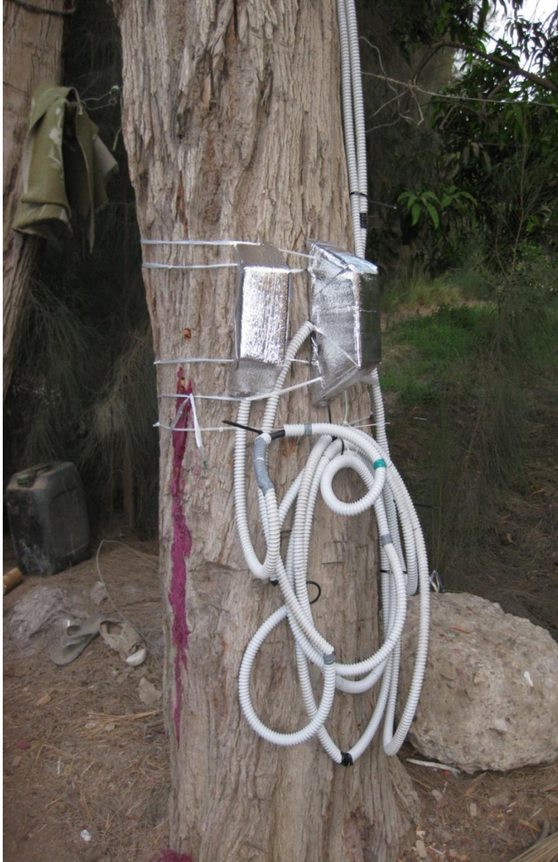
写真 1 サンプル 11 番に設置した sapflow sensor
