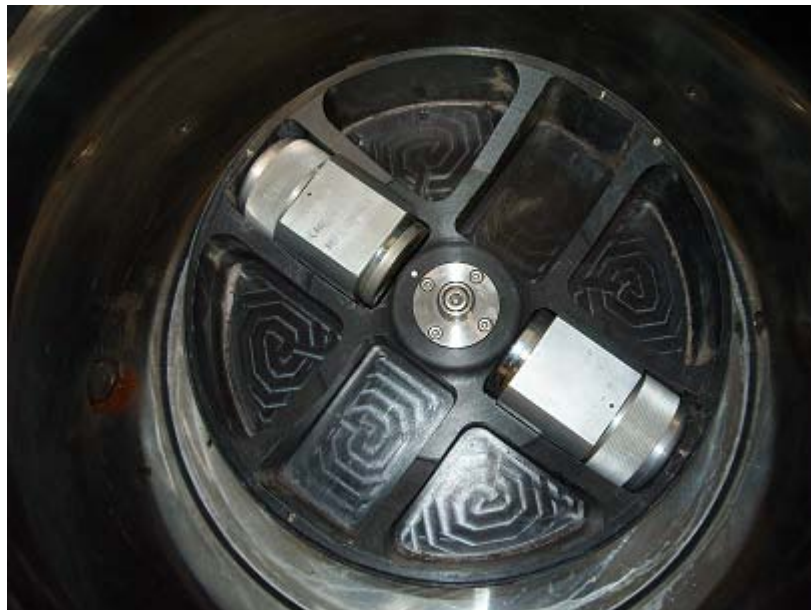
図 15 遠心分離写真. 土壌を円筒に詰めた. また円筒と土壌の全質量が二つのサンプルで同じになるように調節し, 計量した. 遠心分離機の中の様子.
