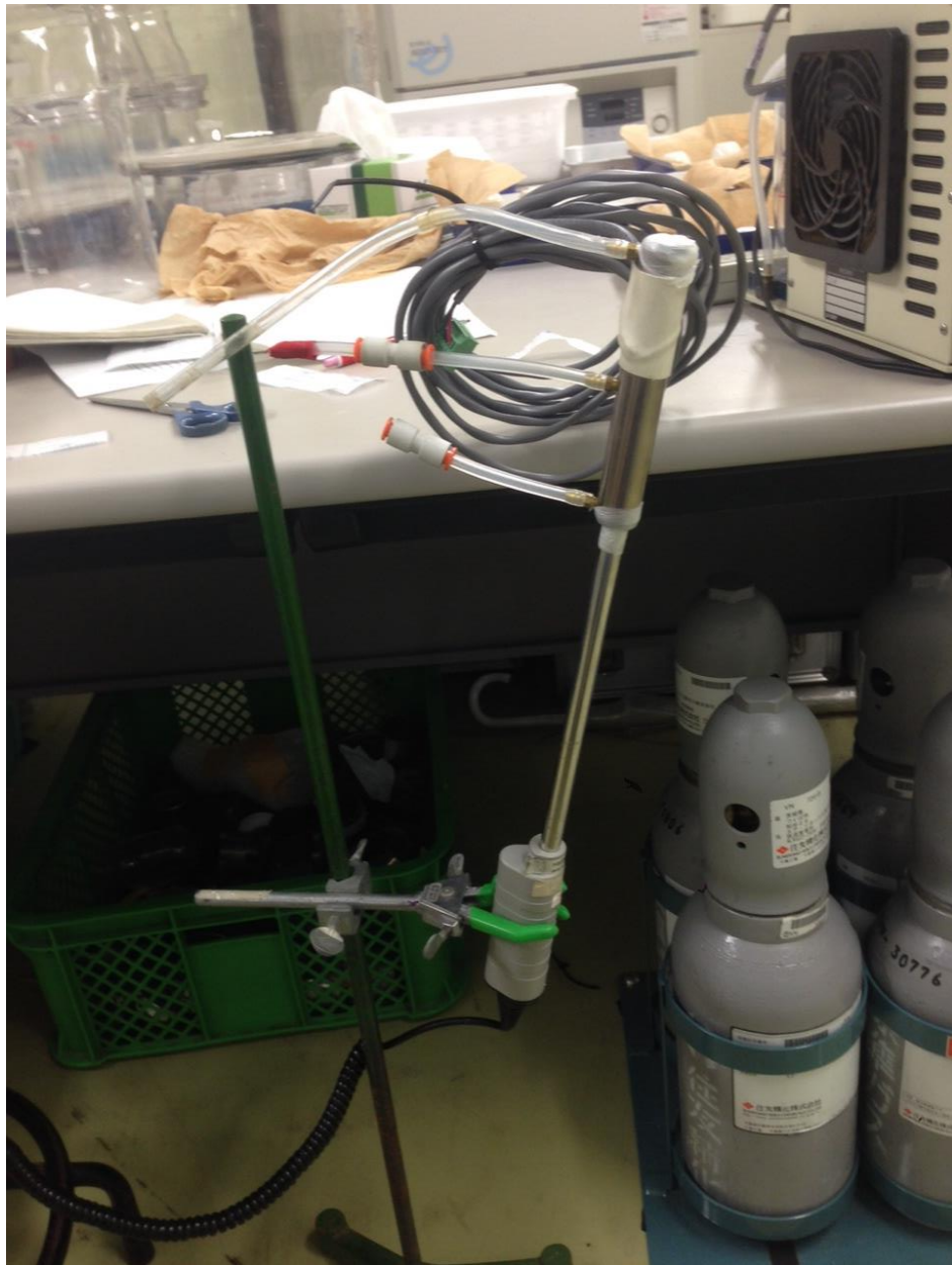
図 19 温湿度測定器(HMI41)のキャリブレーションの様子(2015年11月24日撮影)
