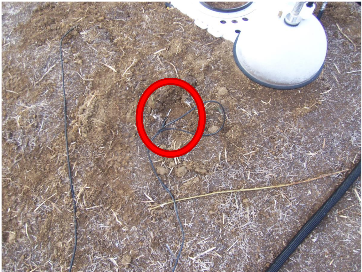
図 7 埋設前の地温計(写真赤枠内) (2015年12月10日撮影)
