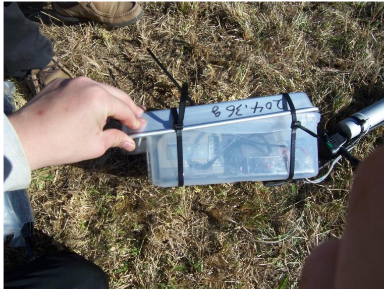
図 13 横から見た雨よけをかぶせた後の放射温度計(2015年12月5日撮影)
