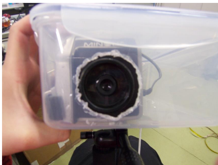
図 12 ケースに入れた放射温度計のレンズ部分(2015年12月5日撮影)
