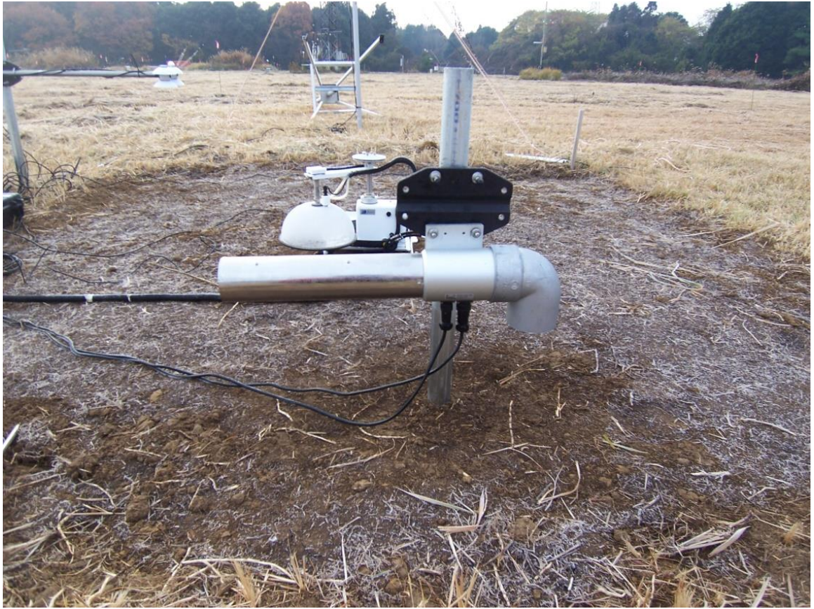
図 22 通風温湿度計の設置状況(2015年12月10日撮影)
