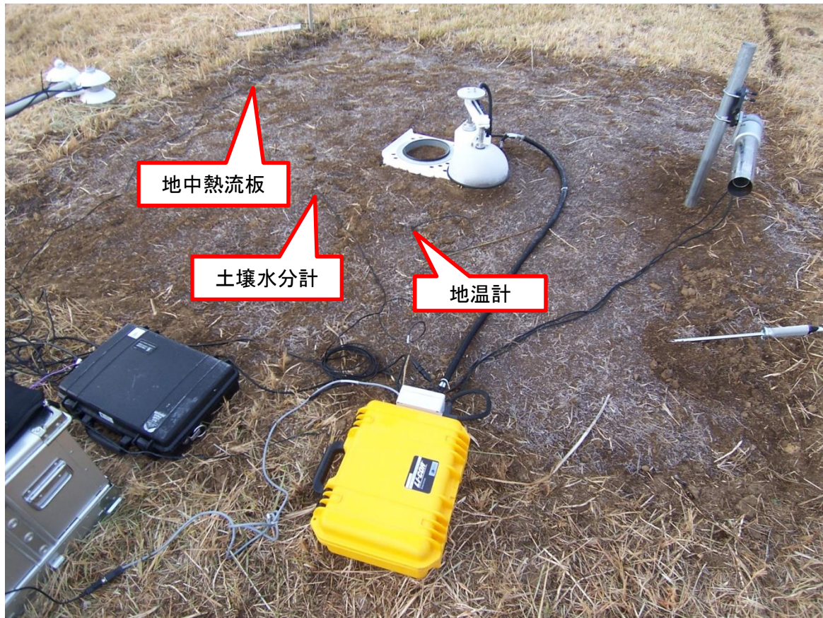
図 4 地中熱流板、土壤水分計、地温計の埋設地点(2015年12月10日撮影)
