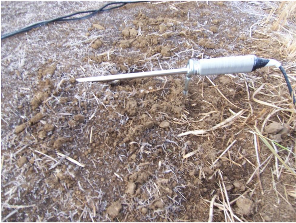
図 17 温湿度測定器(HMP46) の設置状況(2015年12月10日撮影)
