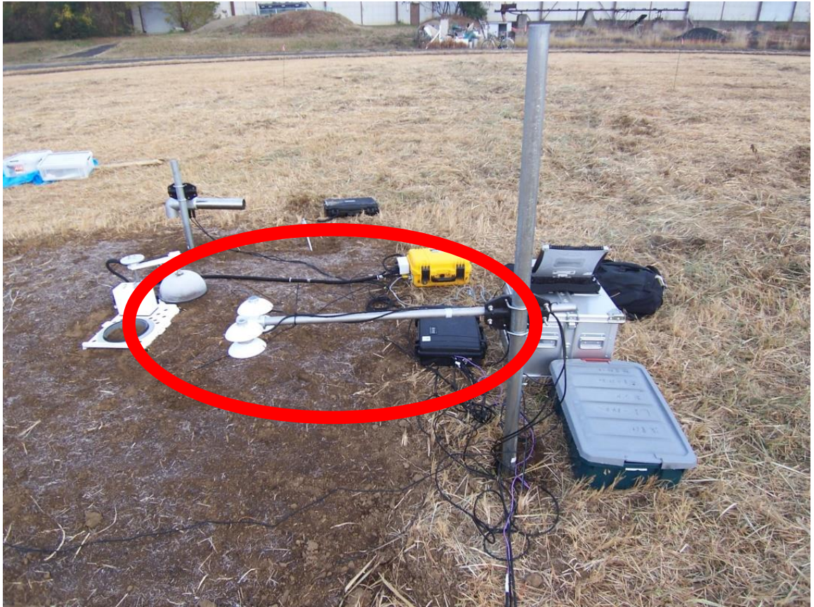
図 26 設置された 4 成分放射計(赤枠内)(2015 年 12 月 10 日撮影)
