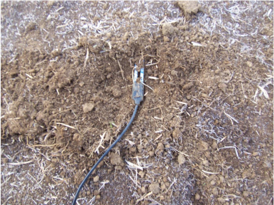
図 8 埋設前の土壤水分計(2015年12月10日撮影)
