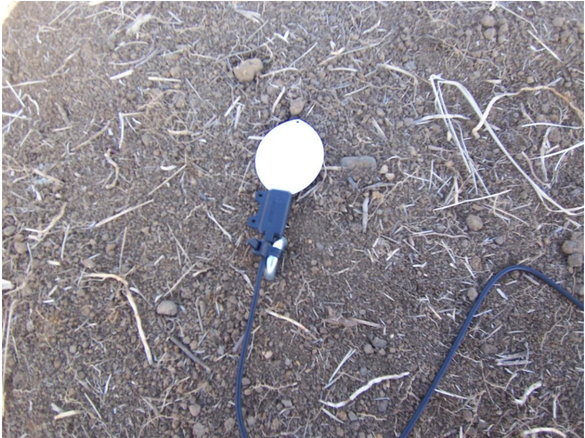
図 27 設置された濡れセンサー(2015年12月10日撮影)
