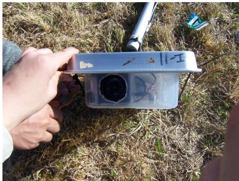
図 14 正面から見た雨よけをかぶせた後の放射温度計(2015年12月5日撮影)
