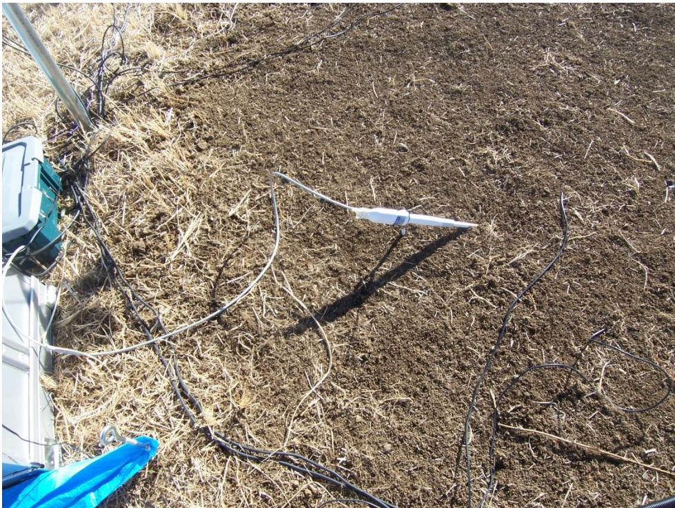
図 18 温湿度測定器(HMP155)の設置状況 (2016年1月21日撮影)
