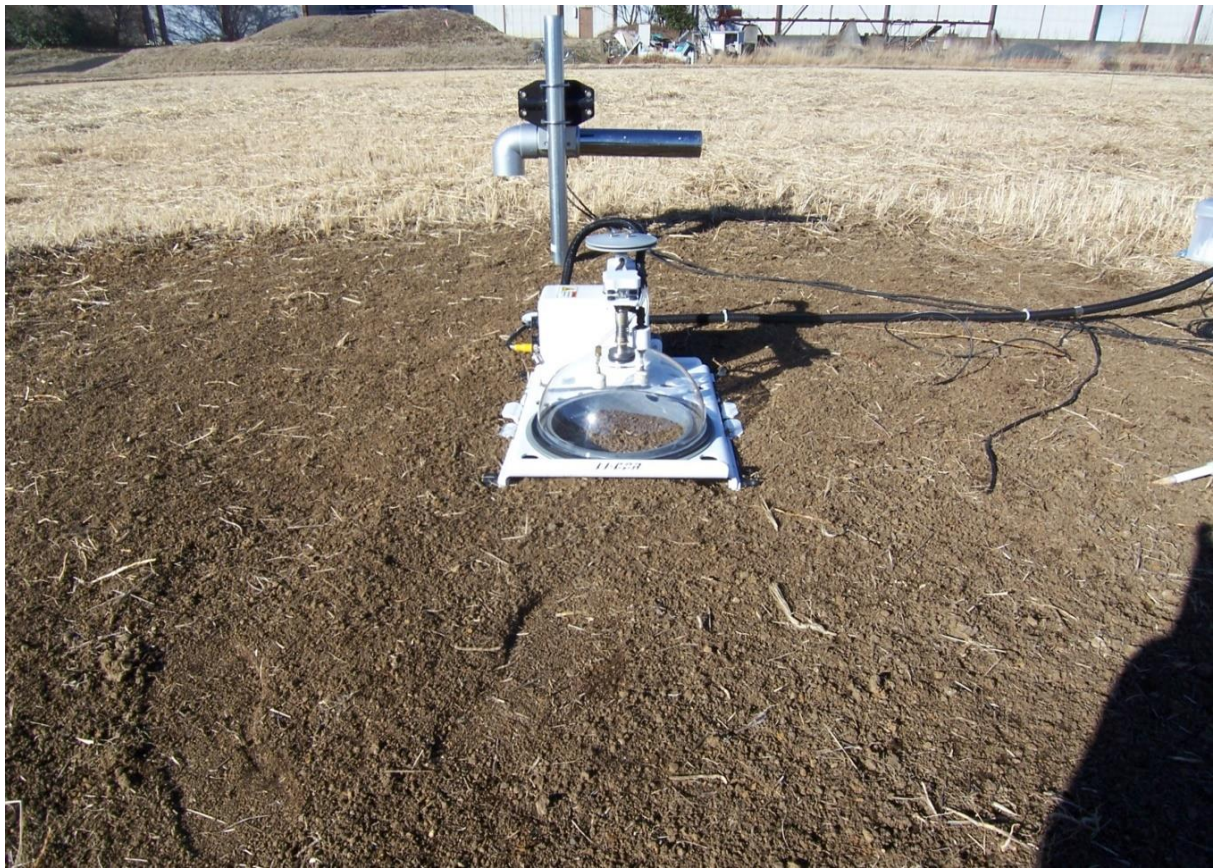
図 6 チャンバーが閉じているときの密閉式チャンバー(2015年12月10日撮影)
