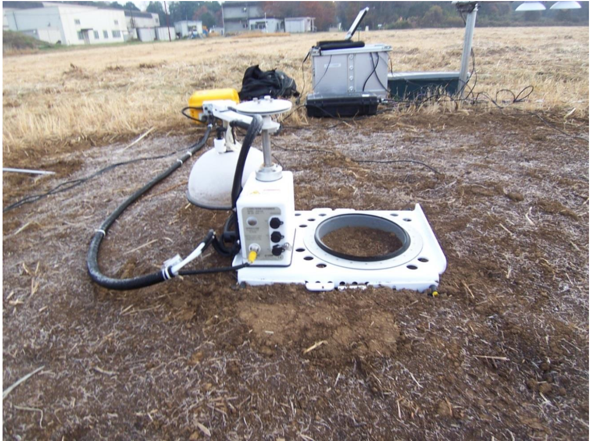
図 5 密閉式チャンバー(チャンバーが開いている状態)(2015年12月10日撮影)
