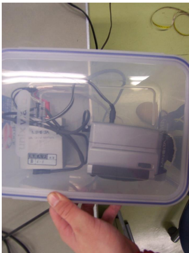
図 11 ケースに入れた放射温度計(2015年12月5日撮影)
