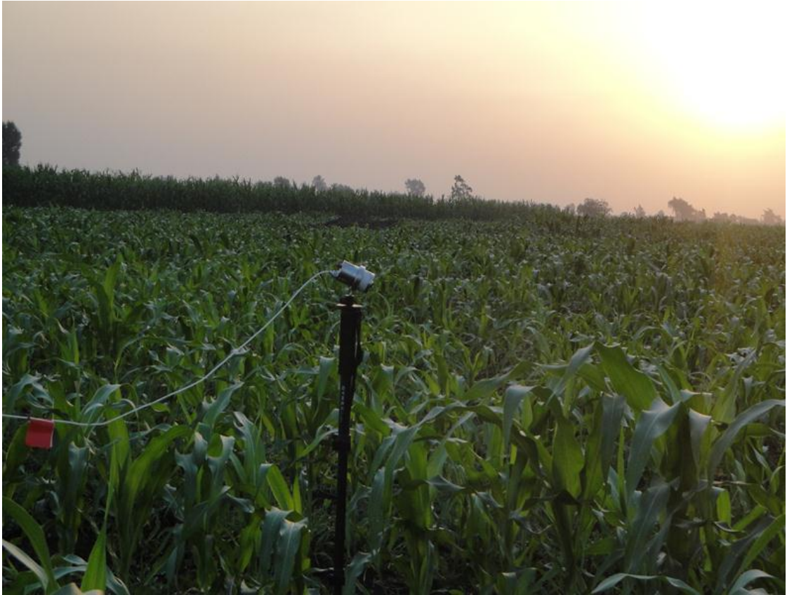
図 18 放射温度計 (EVEREST 4000.4ZL) による観測の様子 (Zankalon にて 2011 年 7 月 21 日撮影)
