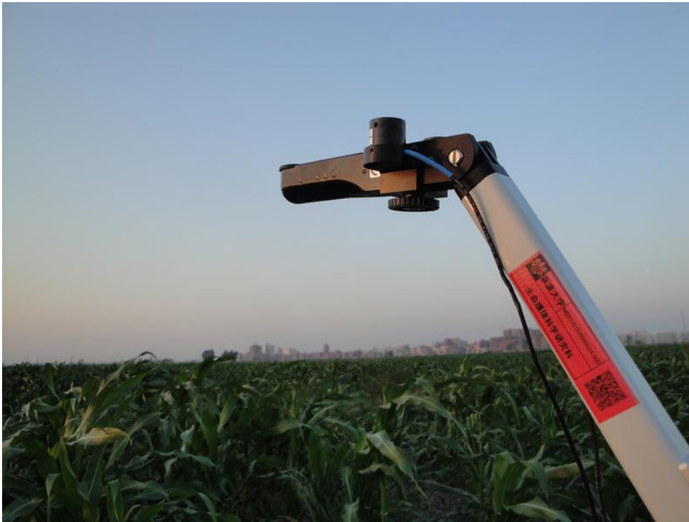
図19.1 キャノピーアナライザーによる植生の上での測定の様子
