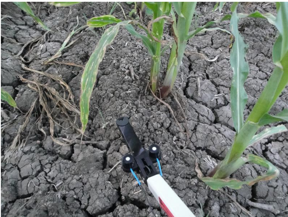
図 19.2 キャノピーアナライザーによる植生の下での測定の様子
