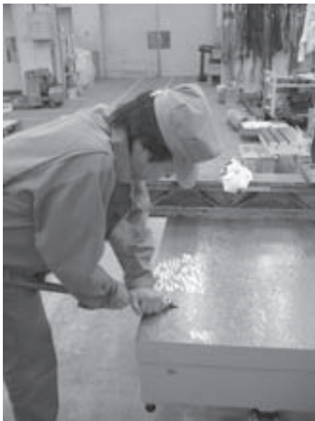
写真6 キサゲ作業の様子 定盤製作の場合、1mあたり2 \mu mの誤差まで達成することが可能である。
