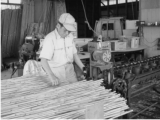
写真5 機械によるヨシズ編み
