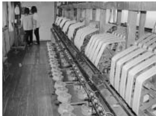
写真4 松沢製糸場の揚返工程の様子 (2004年5月 呉羽撮影)
